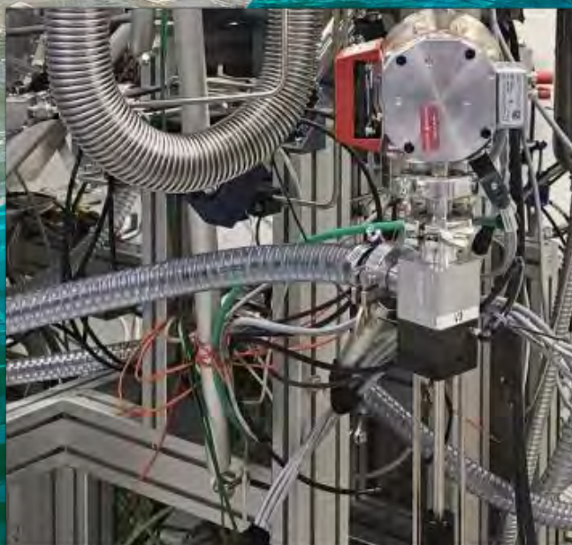
Yliopisto-opettaja Jussi Paavola kertoo, että yliopiston uuden vetytankin hankinnassa oli oltava tarkkana siitä, millaista materiaalia säiliö voi olla. Vetyä pyritti haurastuttamaan metallia ja se on ongelmallista vedyn kulkutiesille ja säilyttämälle.
