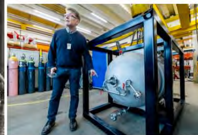
Yliopisto-opettaja Jussi Paavola kertoo, että yliopiston uuden vetytankin hankinnassa oli oltava tarkkana siitä, millaista materiaalia säiliö voi olla. Vetyä pyritti haurastuttamaan metallia ja se on ongelmallista vedyn kulkutiesille ja säilyttämälle.
